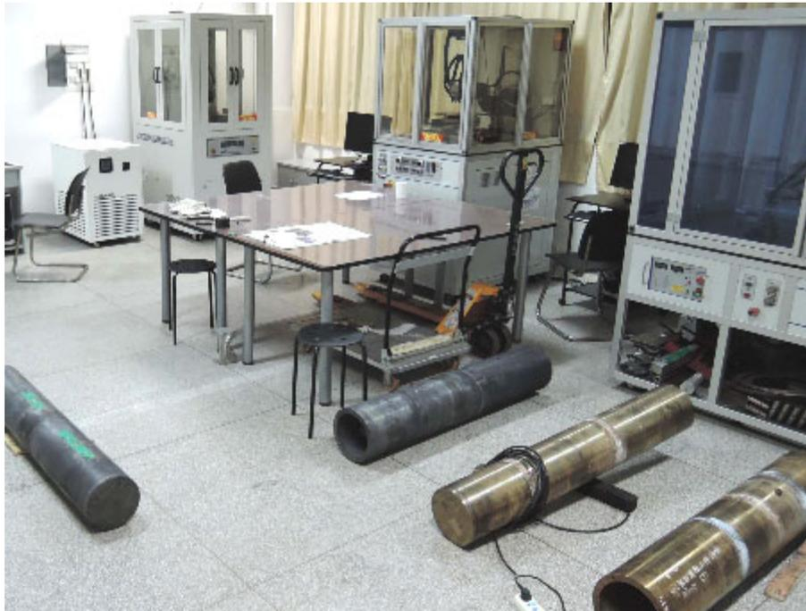
不锈钢管焊缝
