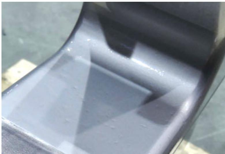
车体零件微粒子喷丸
