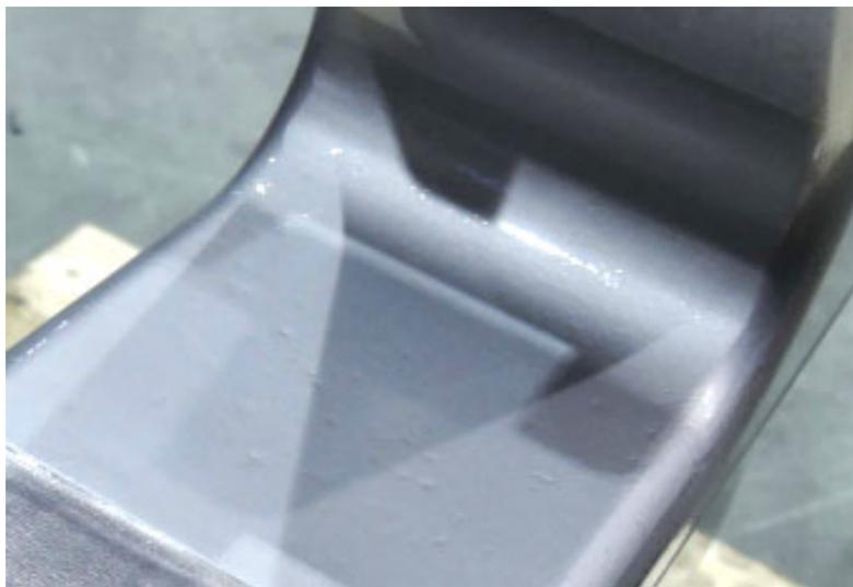
车体零件微粒子喷丸
