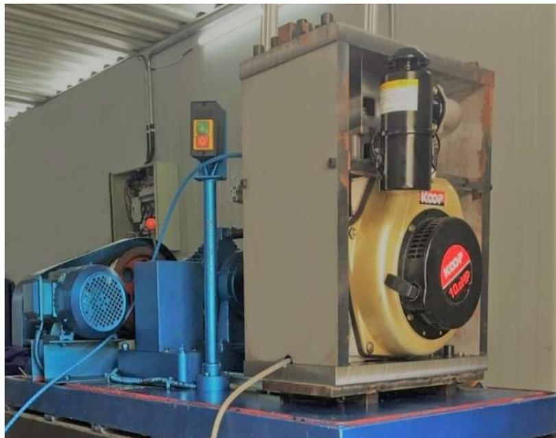
用于研究**活塞组件结构、气缸套表面结构和润滑油性能**对摩擦功的影响规律。
