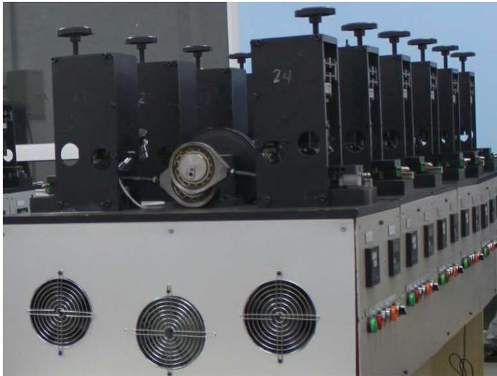
对置往复摩擦磨损试验机
