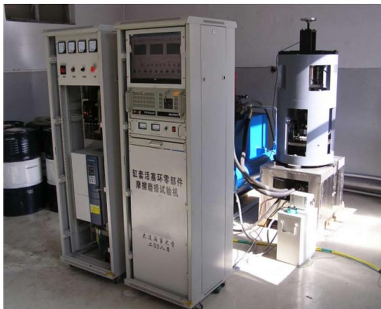
活塞环-气缸套零件级别试验机主要为**径向膨胀加载摩擦磨损试验机**。
