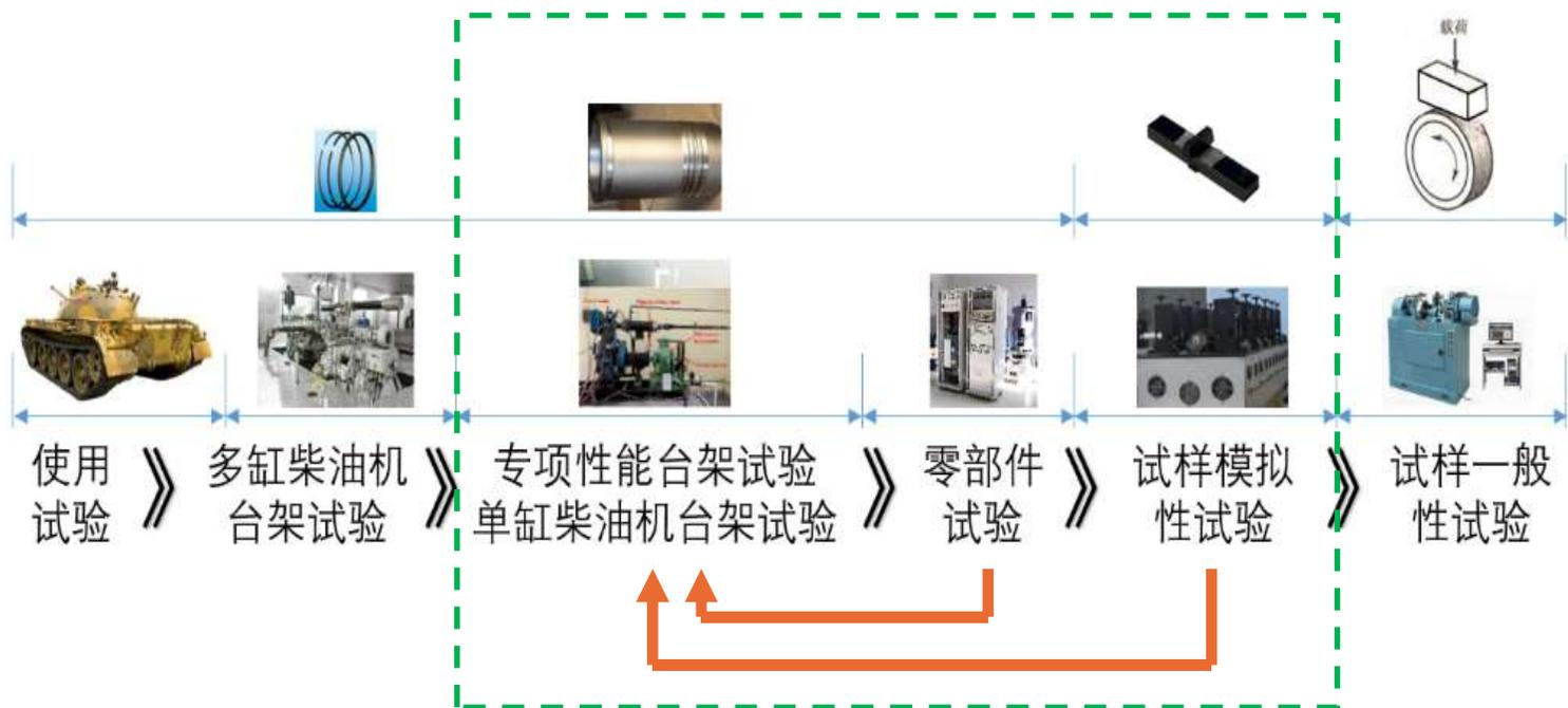
活塞环-气缸套摩擦磨损试验的相似性
