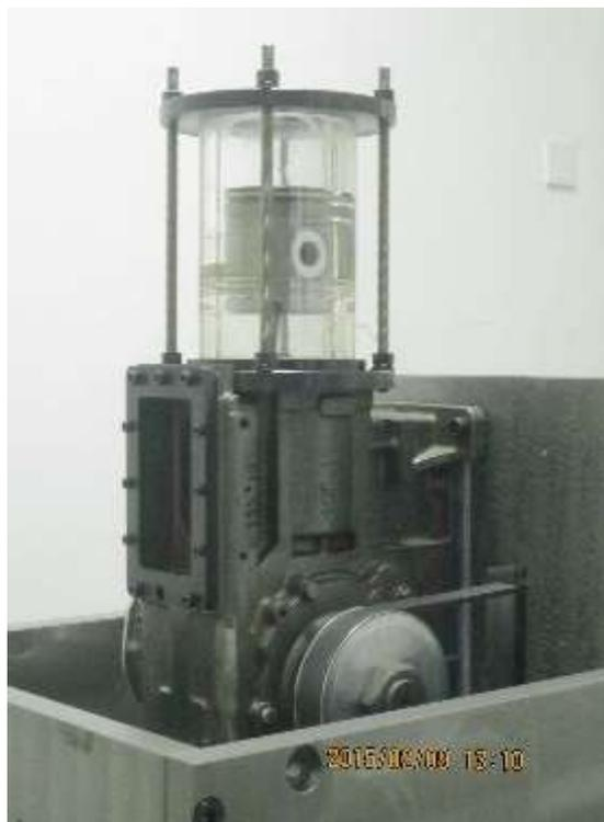
主要结构为单缸柴油机，**气缸套改为石英玻璃**，移除缸盖，加长连杆，采用电动机倒拖，**驱动活塞组件在透明气缸套内往复运动**，**安装平台可90°旋转**。采用**荧光诱导法测量活塞环与气缸套之间的润滑油膜厚度**。
