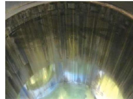
与B活塞环配对气缸套在拉缸后表面形貌
