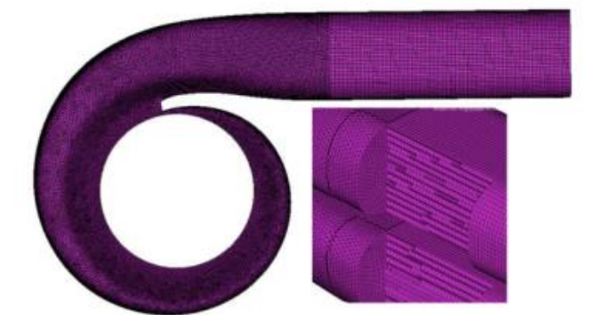
(a) 进气流道网格模型
